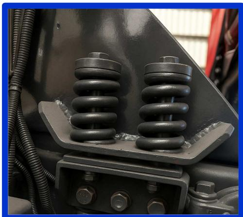
Este conjunto completo incluye resorte de alta resistencia, perno, tuerca y bujes especiales, diseñado para asegurar y absorber impactos en el montaje del chasis de camiones. Ideal para mantener la estabilidad estructural y reducir vibraciones durante el funcionamiento en condiciones exigentes, fabricado con materiales duraderos para una larga vida útil
